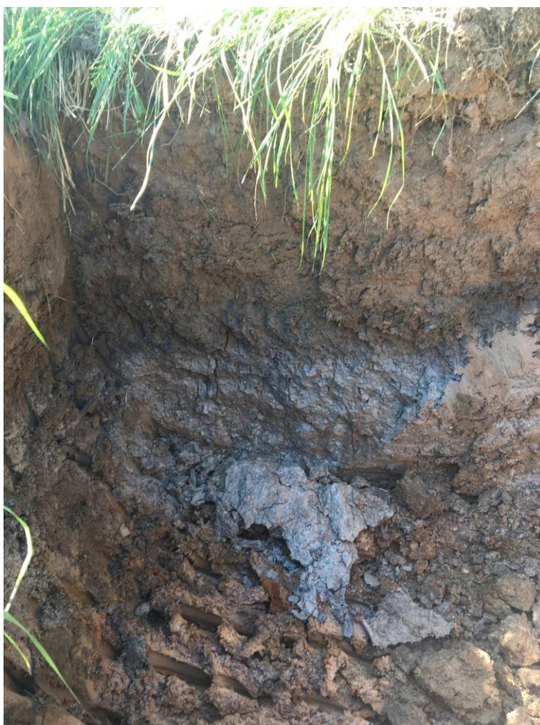
Obrázek č. 11 Geologický profil kopanou vsakovací sondou VS-1
