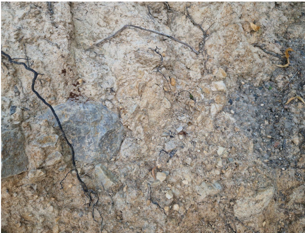
Obr. 13 – Místní sonda – exteriér – plánované umístění výtahu – jílovitá zemina s kusy žuly
