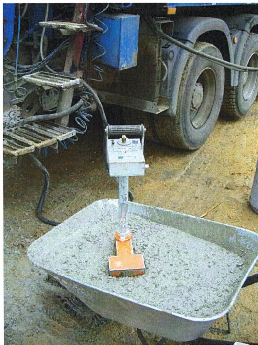
Obr.3 Radiometrická kontrola čerstvého betonu ve zkušební nádobě před čerpáním do bednění
