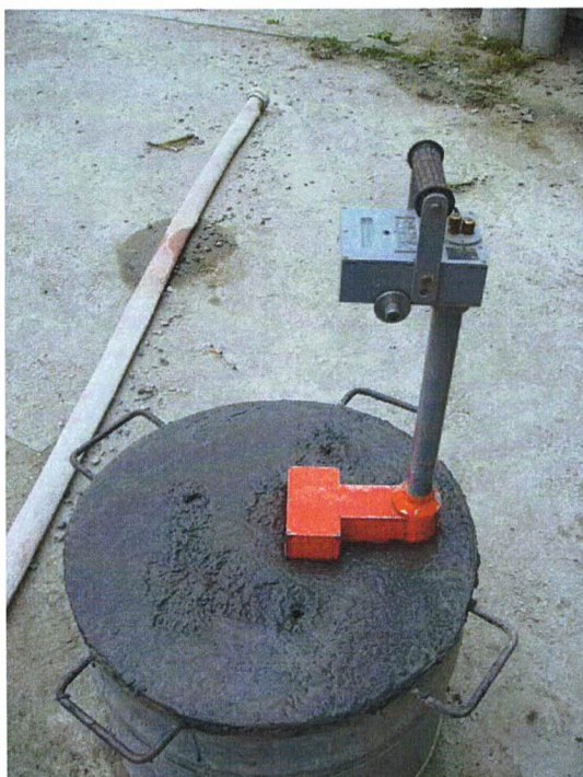
Obr.2 Výroba kalibračního vzorku.
