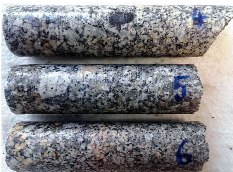
Obrázek č. 5: Vývrtky V4 -V6 z kamenného oblouku NK
