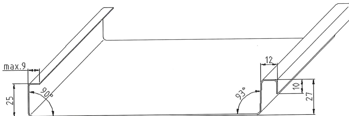
Obr. 1: Úhly a míry na profilu dvojité drážky.
