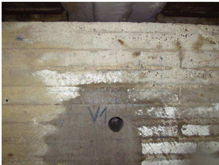
zkušební vývrt V1, stanovení kvality betonu
